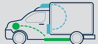
Une ou plusieurs batteries sont installées dans le véhicule pour alimenter le groupe frigorifique. Quand la ePTO n'est pas disponible sur un modèle de véhicule, nous avons recours à des batteries indépendantes pour alimenter le groupe frigorifique. Attention, des batteries indépendantes supposent d'avoir accès à deux points de charge.
