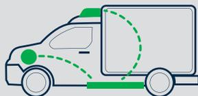
Le groupe frigorifique est directement alimenté par les batteries de traction du châssis. Tous les poids lourds frigorifiques utilisent cette technologie ainsi que certains modèles de véhicules utilitaires légers.
